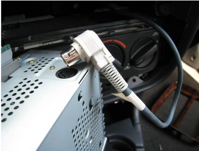
Dies ist der Stecker der Verlängerung am Radio, der kann prinzipiell stecken bleiben, es sei denn, man möchte den neuen Wechsler testen, bevor man den alten ausbaut. Die anderen Anschlüsse habe ich dran gelassen, um nachher den Radiocode nicht wieder eingeben zu müssen. Am besten, man legt die Mittelkonsole mit einem dicken Handtuch aus und umwickelt auch das Radio damit, um Kratzer zu vermeiden.
