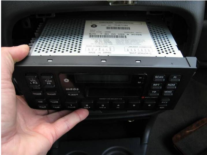
Jetzt das Radio vorsichtig rausziehen und den DIN-Stecker von der Verlängerung abziehen, der mit dem Wechsler verbunden ist. Der Stecker auf der Wechslerseite hat einen kleinen Sperrnippel, der gedrückt gehalten werden muss, um den Stecker zu entriegeln. Stecker und Buchse sind mit Schaumstoff ummantelt.
