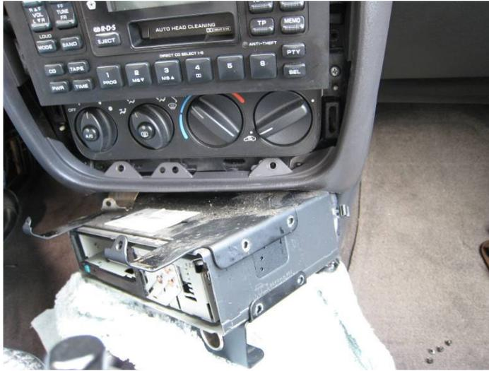
Jetzt kommt der schwierigste Teil: den Wechsler rausziehen. Hier braucht man Gefühl, Geduld und Kraft in den Fingern. Ich habe durch den offenen Radioschacht mit einer Hand von hinten gedrückt und geschoben und mit der anderen von vorn gezogen. Es ging anfänglich nur millimeterweise und unter hohem Kraftaufwand. Aufpassen, dass beim Ziehen die Laschen der schwarzen Montageplatte nicht am Frontrahmen des Armaturenbrettes hängen bleiben und dieses beschädigen.
