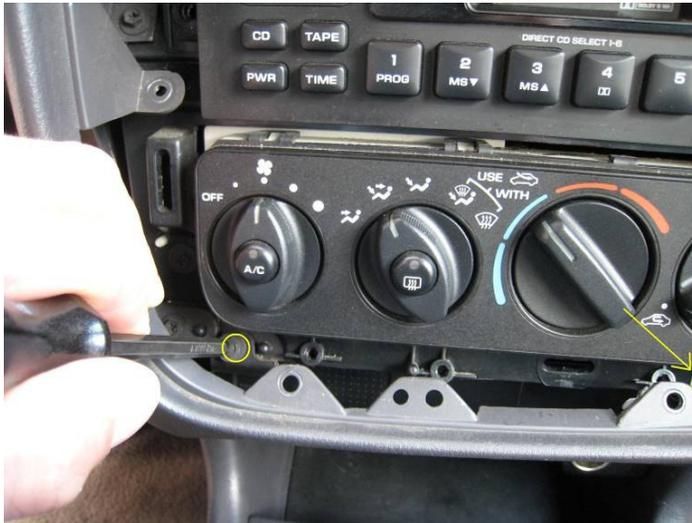
Nun den Rahmen leicht etwas vorziehen, damit die beiden verdeckten Schrauben der Montageplatte des Wechslers mit einem Kreuzschlitz rausgeschraubt werden können.
