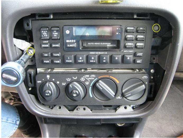
Das Radio muss auch ausgebaut werden, daher sind die beiden markierten Sechskantschrauben mit einer 10er Nuss rauszuschrauben. Das Radio kann danach noch sehr fest sitzen, als wenn es noch anderweitig befestigt ist. Es wird aber nur mit diesen beiden Schrauben gehalten, daher etwas ruckeln oder seitlich mit einem Schraubendreher hebeln, bis es locker ist.
