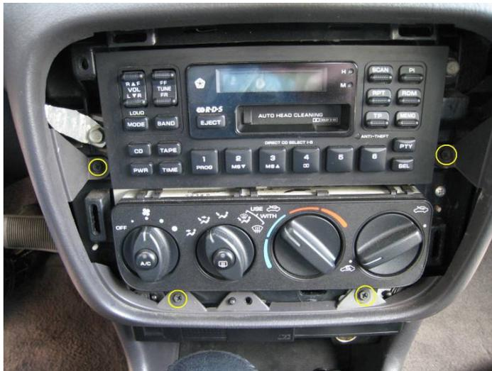
Mit einem Kreuzschlitz-Schraubendreher die 4 gelb markierten Schrauben rausdrehen. Dadurch lässt sich der Rahmen der Mittelkonsole im übernächsten Schritt etwas vorziehen um an weitere Schrauben zu gelangen.
