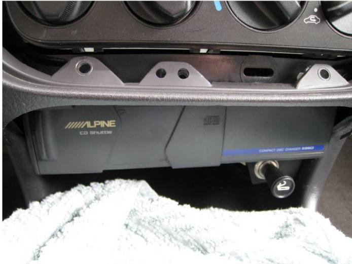
Nachdem der neue Wechsler auf die schwarze Montageplatte geschraubt wurde und der Zigarettenanzünder wieder montiert ist, empfiehlt es sich, den Stecker des Wechslers an die Verlängerung anzuschließen und dann das Kabel durch den Radioschacht herauszuziehen. Dann wird der Wechsler wieder unter die messingfarbene Montageplatte geschoben (diese wird nicht ausgebaut, sondern verbleibt, wo sie ist). Der Zusammenbau erfolgt dann in umgekehrter Reihenfolge. Viel Erfolg!
